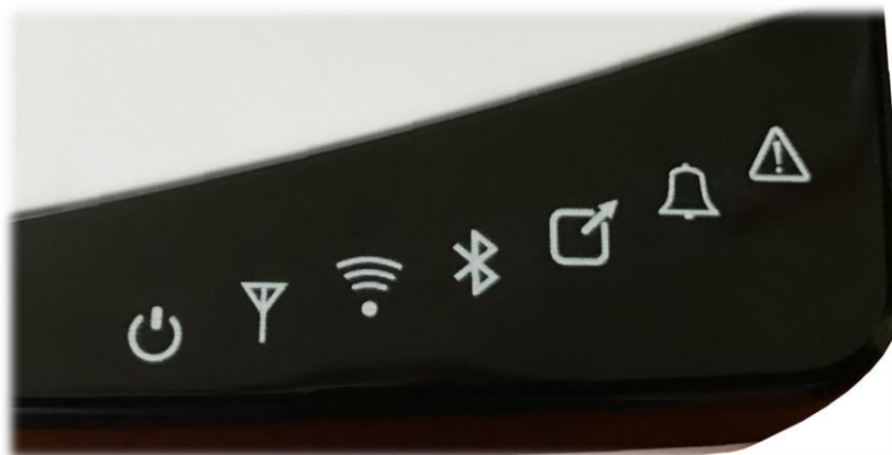
Zeichnung 1 – Optische Betriebszustandsanzeigen
